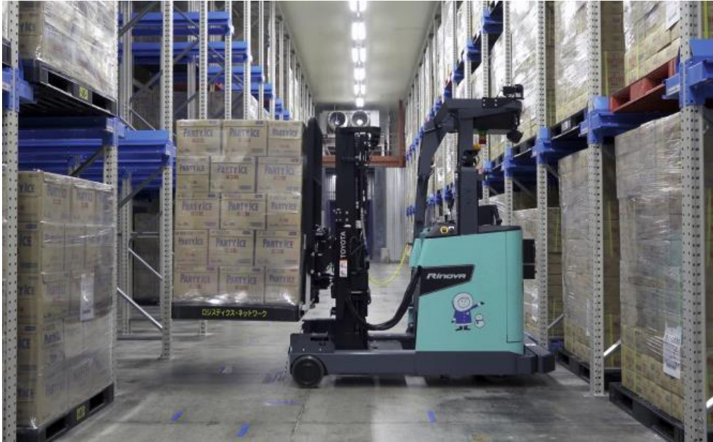
冷凍倉庫内で作業するリーチタイプ冷蔵・冷凍自動運転フォークリフト
